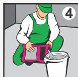
**4** Для подготовки раствора залейте водопроводную воду комнатной температуры в чистую ёмкость из расчёта 0,40 - 0,44 л воды на 1 кг сухой смеси.
